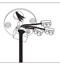
3 Deckenbecher auf die Montagescheibe schieben und mit der Schraube festziehen.
