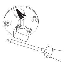
**2** Kabellänge festlegen und Kabel in der Zugentlastung (1) befestigen.
